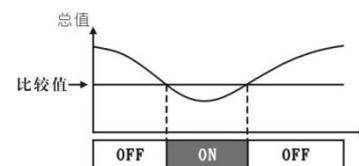
HP-S 表示总值与给定值 Au 的正偏差 > 比较值时, 输出导通
