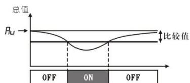
HLPS 表示 总值与给定值 Au 的偏差绝对值 > 比较值时, 输出导通
